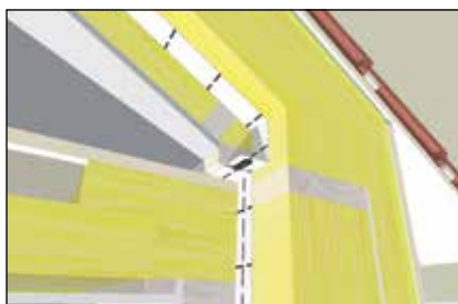
Snedtak: Varm vind
