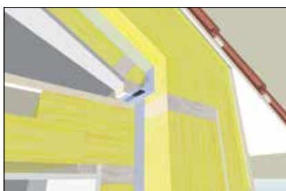
Snedtak: Varm vind
